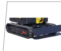
Tren de rodaje de goma: Alambre de acero de refuerzo incorporado, resistente al desgaste y duradero. No daña el cemento ni el suelo de baldosas.
